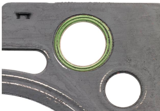
Рис. 3. Загрязнения герметиком по внешнему краю зеленого эластомерного уплотнительного элемента и на уплотняемой поверхности.
